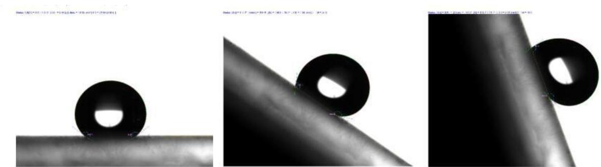
二、离心旋转台法（即滞留力天平法），实验是将一个液滴置于待测的样品表面后，利用离心旋转台使液滴沿着圆周转动，同时跟踪并记录液滴形状、接触角和位置的变化。
